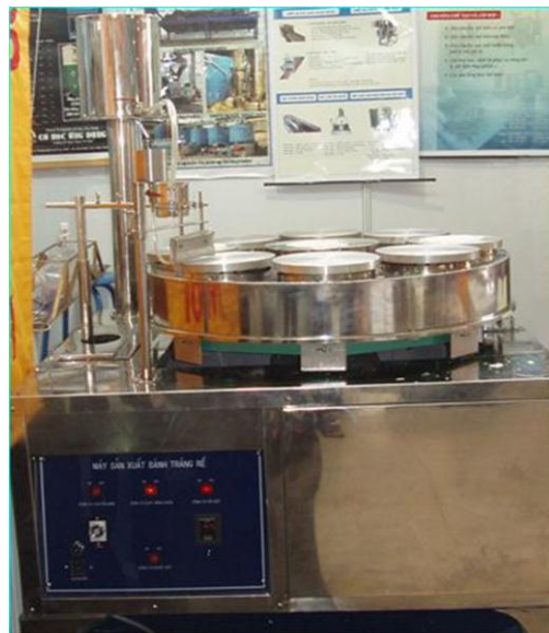
Hình 1.5: Máy bánh tráng rế dùng cơ cấu tay quay – con trượt
